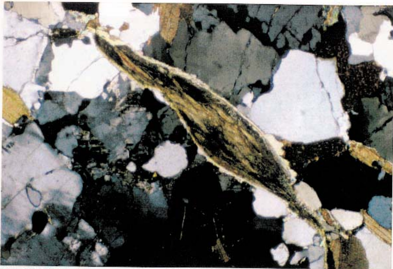
Foto B. MG-7: Microtextura coronítica, con borde reaccional de moscovita, de un sigmoide de fibrolita. NC x 44 .
