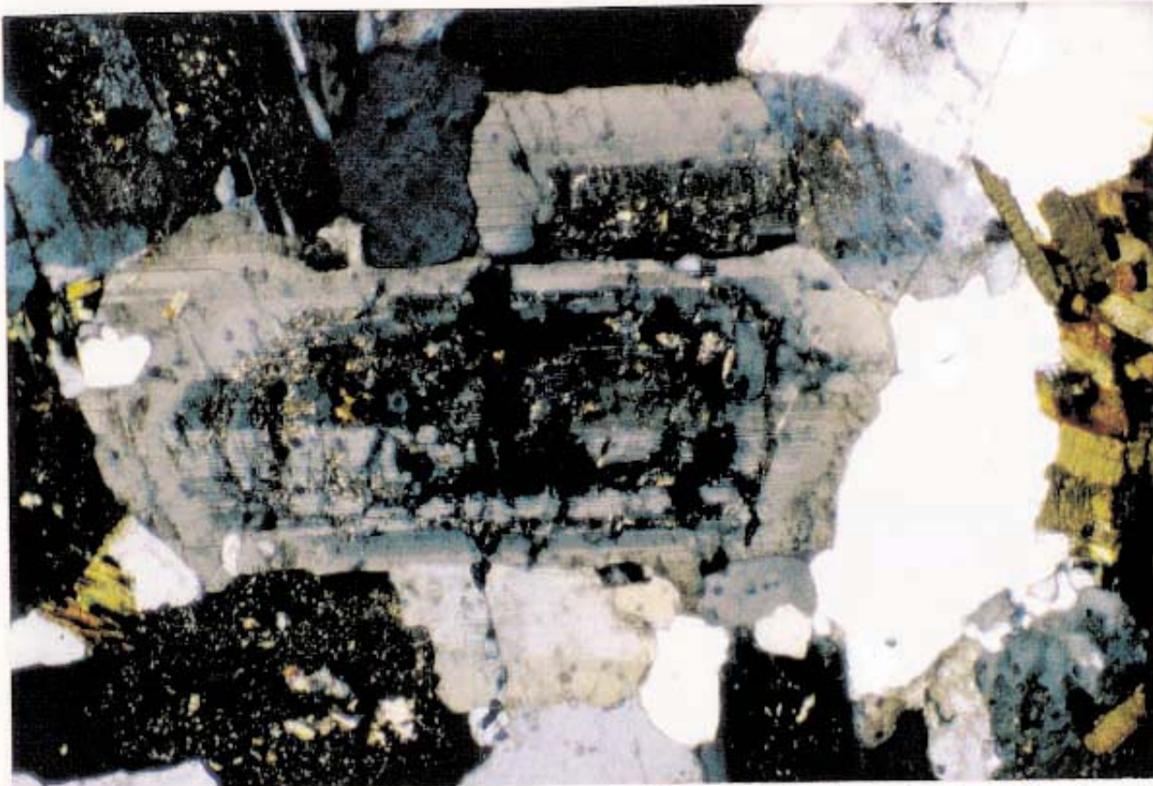
Foto A. MG-5: Sineusis triple. Zonado discontinuo e inclusiones de tipo Frasl en la plagioclasa de mayor tamaño. NC x 44 .
