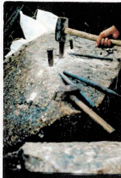
Foto-1: Detalle del muestreo con ayuda de cuñas.
