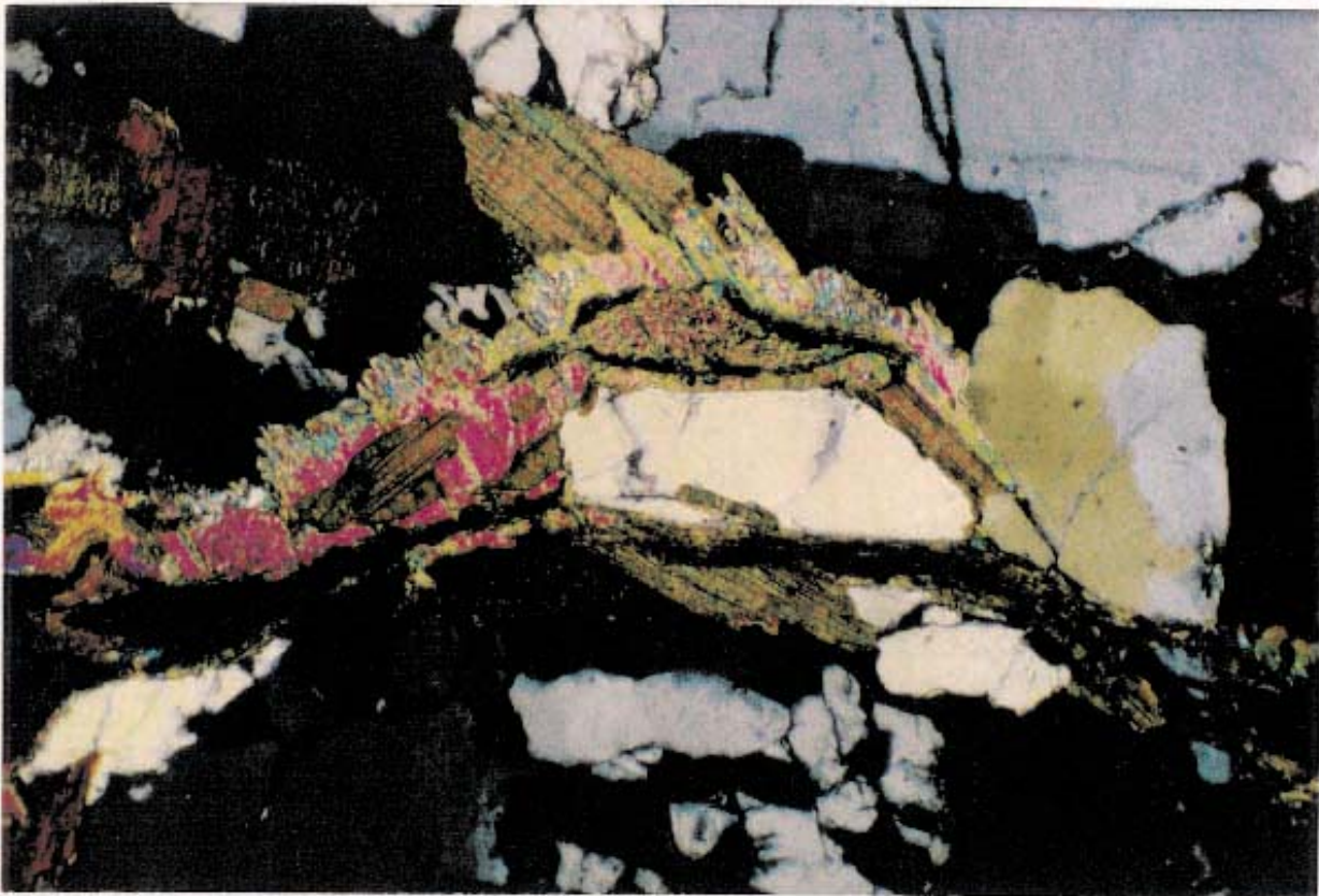
Foto A. MG-7: Cuarzo rodeado por biotita y fibrolita. Véase el "rim" de moscovita secundaria con borde dactiliforme con cuarzo. NC x 44.
